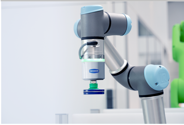
Elektrischer Vakuum-Erzeuger ECBPMi bei der Handhabung von Dosen
